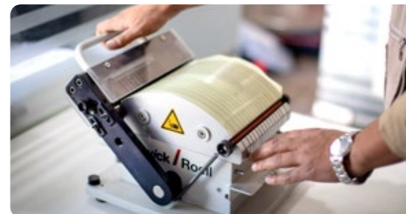
قص جميع العينات للمختبر بجهاز خاص للقص حيث يتم قص العينة بما يتناسب مع ما تحتاجه اجهزة الفحص
