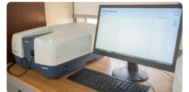
معرفة الخصائص البصرية للبلاستيك من نفاذية وتشتيت للضوء ومدى مطابقتها مع ما هو مطلوب من حيث الموقع الجغرافي للبيت وما يحوي من محصول، من خلال جهاز النفاذية والتشتيت
