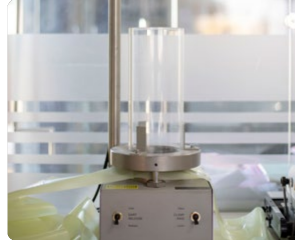
معرفة الخصائص الميكانيكية لتحمل قوة البلاستيك للطرق على عرض البالون كاملا مع فحص جميع مناطق الطي ومدى تحملها من خلال جهاز الطرق
