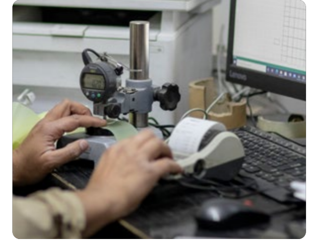
التأكد من ان سماكة المنتج ضمن السماحية المعيارية بواسطة جهاز المايكرومتر
